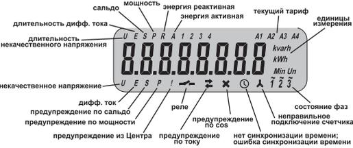
Рисунок Б.1 - Информация, выводимая на дисплей
