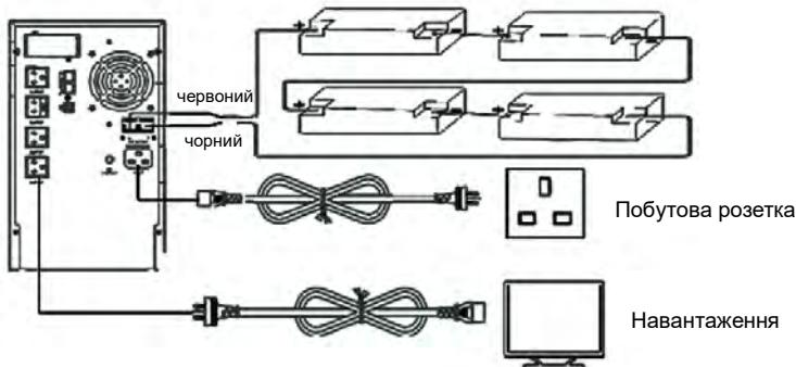
Рис. 3.2.3 Схема підключення батарей до LP UL3500VA
