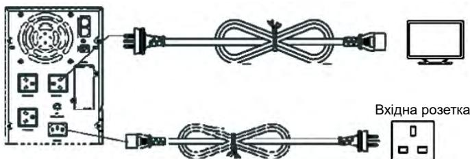
Рис. 3.2.2 Діаграма підключення LP UL2200VA
