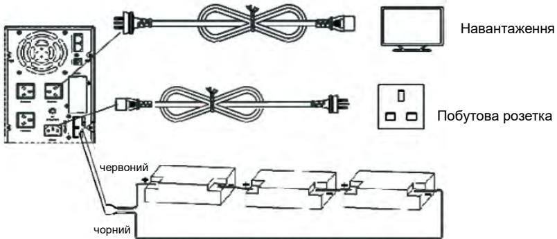
Рис. 3.2.3 Схема підключення батарей до LP UL2200VA
