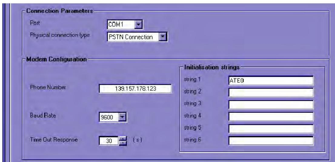
Теперь с помощью программного пакета AIMS PRO (Dino+) можно связаться со счетчиком и считать его данные точно так же, как и с помощью обычного модема.
