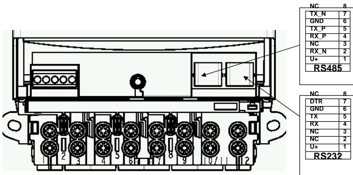
Счетчик ACE 6000 может иметь **один коммуникационный порт**: RS232 или RS485, подключение к которому осуществляется посредством разъема RJ45.
