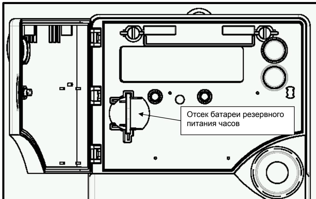
Литиевая батарея резервного питания часов обеспечивает работу часов счетчика при отсутствии напряжения на счетчике в течение 3 лет (полный срок службы батареи – 10 лет). Электроника счетчика контролирует состояние батареи и формирует сообщение об аварийном состоянии батареи, если прошло более 80% срока ее службы или напряжение батареи стало менее 2,0 В.
