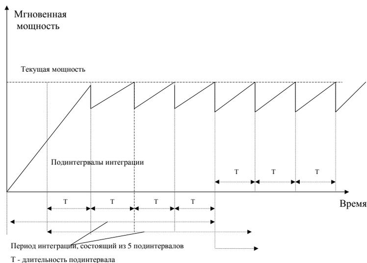
В течение одного расчетного периода (не путать с периодом интеграции) счетчик сохраняет в отдельных регистрах до 5-ти значений максимума нагрузки, среднее и минимальное значения 3-х фазного  $\cos \varphi$  с датами и временем фиксирования. Максимумы нагрузки могут сохраняться в кумулятивном виде или отдельно, для каждого расчетного периода (т.н. «нетто» значения).
