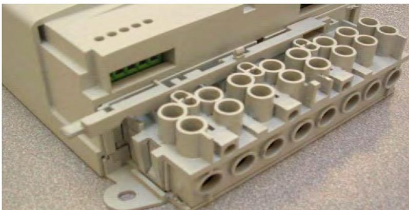
К клеммам напряжения и терминалам управляющих (импульсных) выводов можно подключать провода сечением до 2,5 мм<sup>2</sup> (крепежные винты М3), а к токовым клеммам – провода сечением до 25 мм<sup>2</sup> М (крепежные винты М6).
