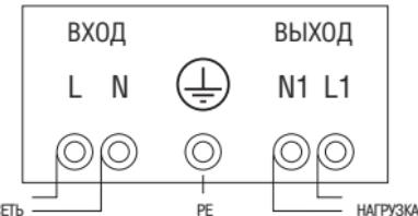
Рисунок 4. Схема подключения стабилизаторов.
