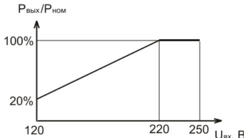
Рисунок 1. Зависимость выходной мощности от входного напряжения, где  $U_{\text{вх}}$  – входное напряжение,  $P_{\text{вых}}$  – выходная мощность,  $P_{\text{ном}}$  – номинальная (паспортная) выходная мощность.
