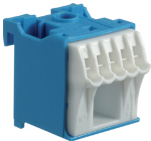
QuickConnect N-клема 1x16mm 2 +5x4mm 2 ширина 30mm
