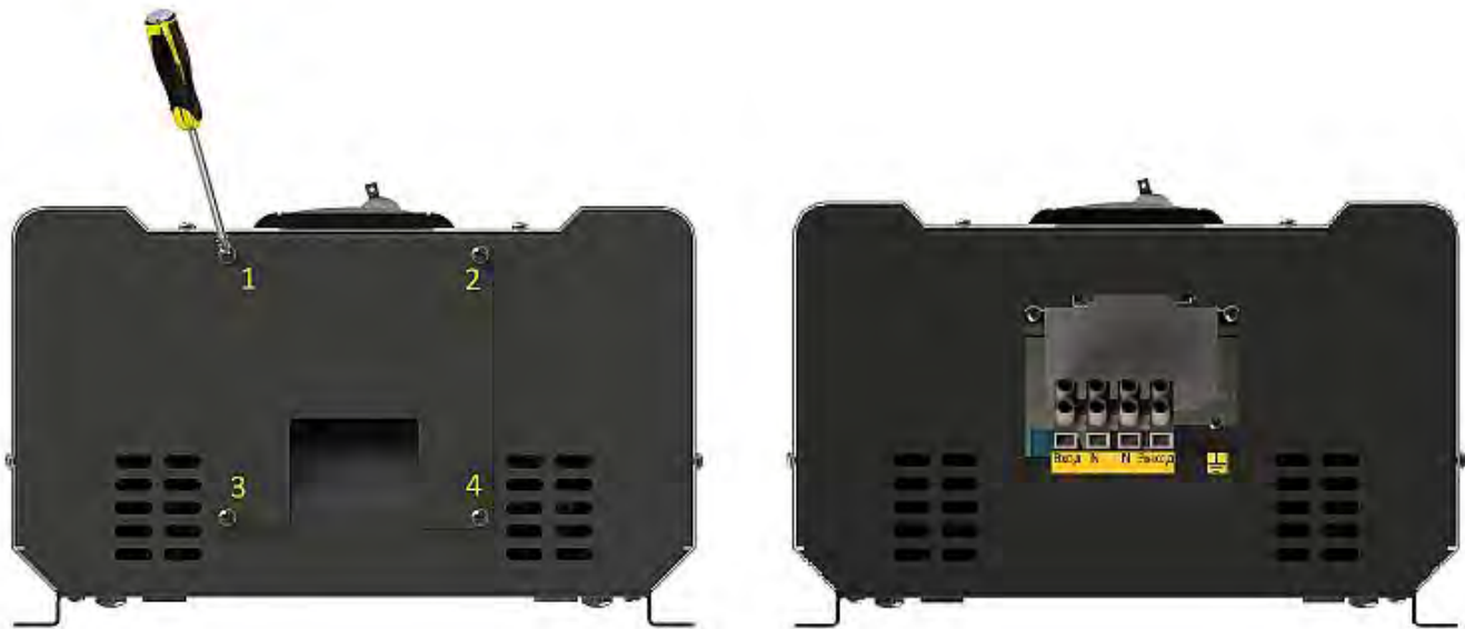
Рисунок 8. Схема зняття захисної кришки знизу корпусу стабілізатора
