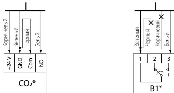
Подключение датчика к блоку управления осуществляется с помощью кабеля, выведенного на кронштейн крепления датчика.
