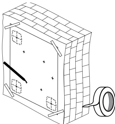
**2.1.** Снимите шаблон и вы сверлите два сквозных отверстия Ø 120 мм для круглых воздуховодов.
