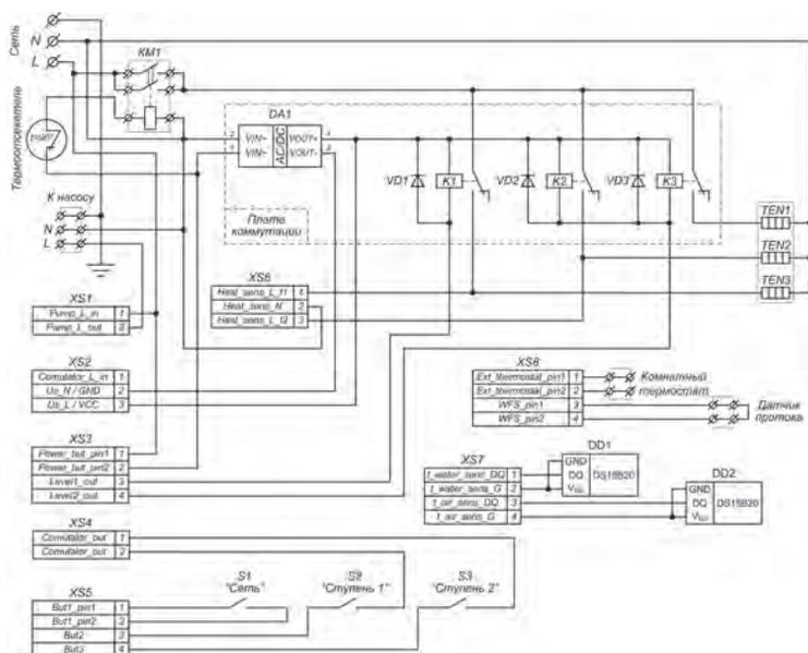
Схема электрическая принципиальная котла Tenko «Econom Digital». Напряжение питания котла- 220В, Напряжение питания ТЭН -220В.
