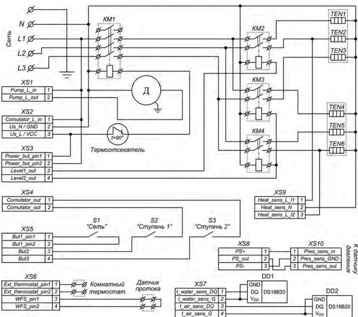
Схема электрическая принципиальная котла Tenko «Standart Digital+». Напряжение питания котла- 380В, Напряжение питания ТЭН -220В, 2 блока
