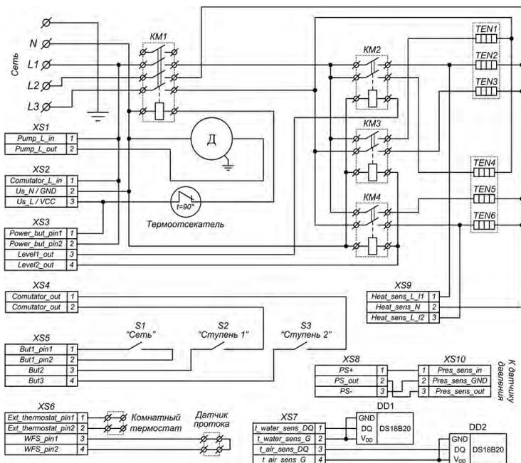
Схема электрическая принципиальная котла Tenko «Standart Digital+». Напряжение питания котла- 380В, Напряжение питания ТЭН -380В, 2 блока
