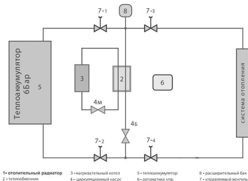
1- отопительный радиатор 2 - теплообменник 3 - нагревательный котел 4 - циркуляционный насос 5 - теплоаккумулятор 6 - автоматика упр. 7 - управляемый вентиль 8 - расширительный бак
