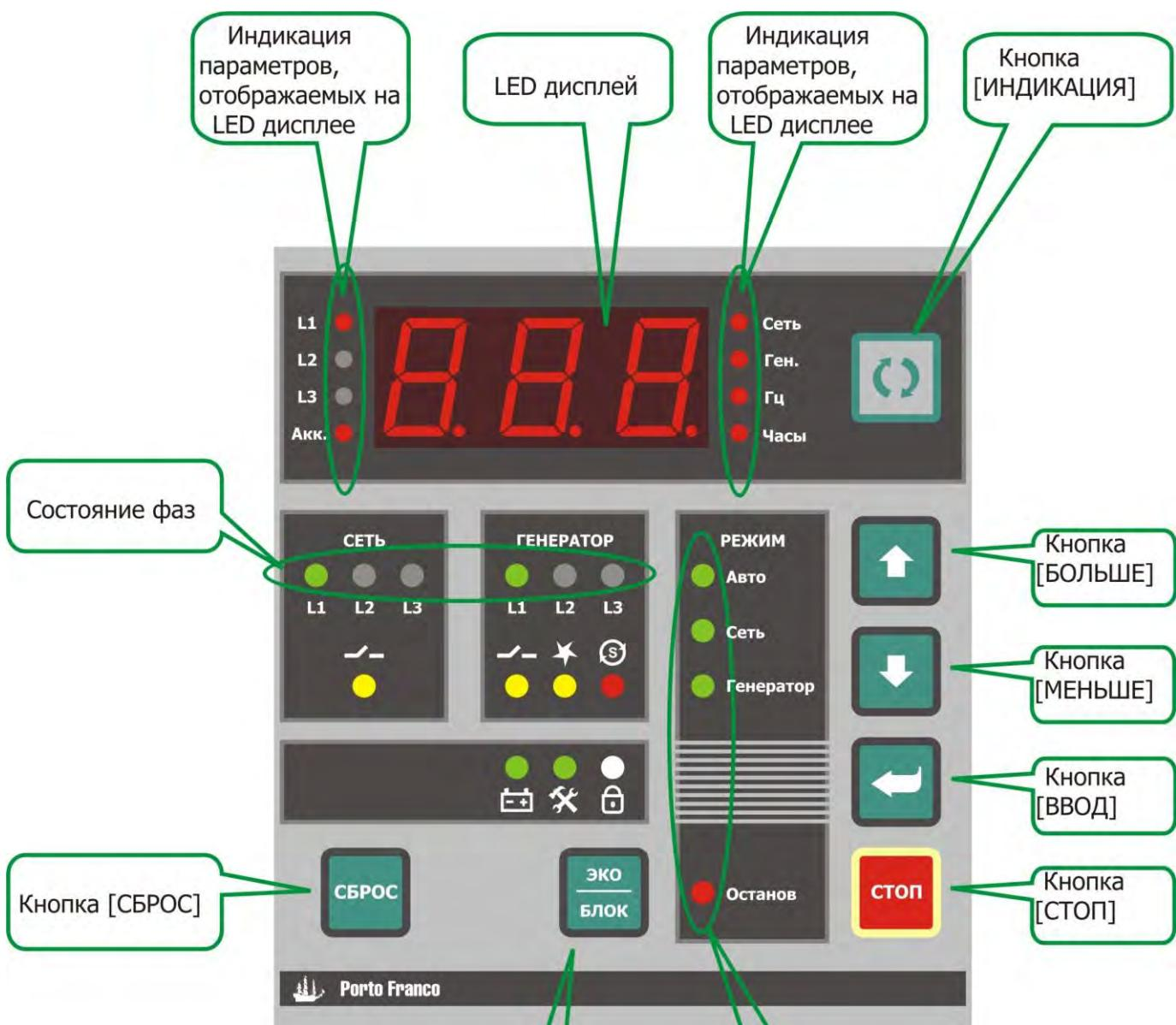
Рис. 5.2. Панель индикации и управления
