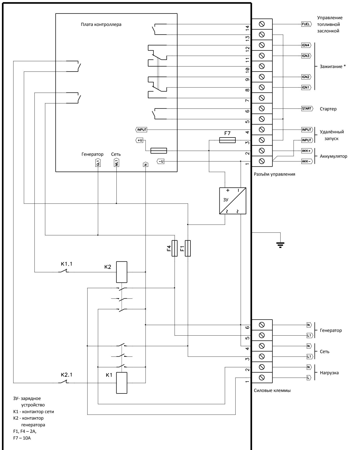
Рис 6.2. Пример схемы подключения контроллера ABP11ME / ABP11CE.
