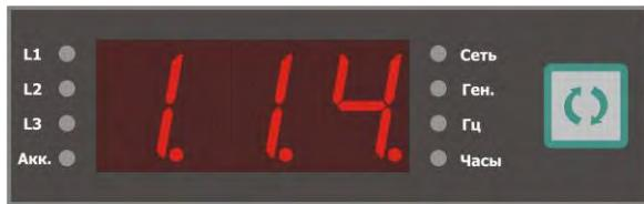
Рис. 5.6. Пример: параметр №114, доступный для редактирования значения.
