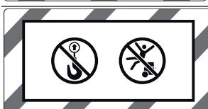
Не подвешивайте пылесос на крюк крана, напр., для транспортировки. Пылесос не пригоден для подъема краном. Это чревато травмами и повреждением пылесоса.
