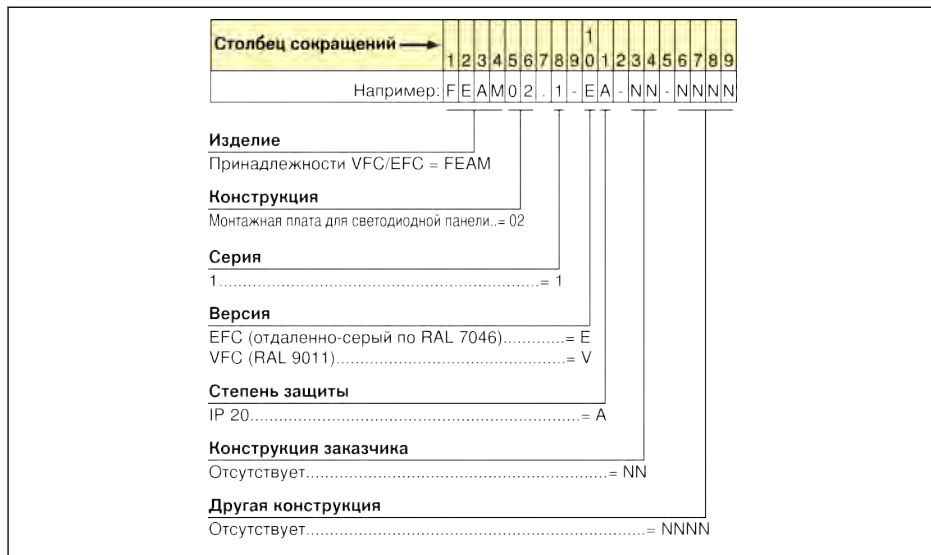
Рис. 19-4: Типовой код монтажной платы пульта управления
