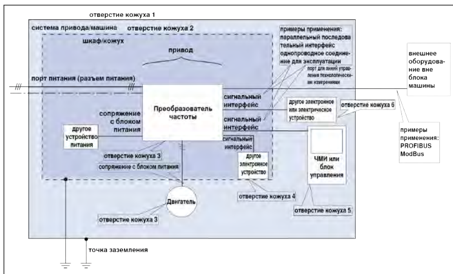
Рис. 9-1: Помехоустойчивость системы привода
