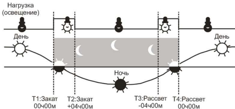
Рисунок 3.3 – Освещение улицы на примере астрономического режима работы
