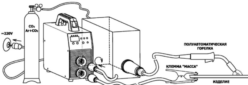
**Внимание!** В качестве защитного газа применяется при сварке чёрных металлов в простейшем случае углекислый газ "CO<sub>2</sub>", а при сварке алюминия только инертные газы типа аргон "Ar", иногда дорогой гелий "He", как альтернатива для нержавеющих и высоколегированных сталей часто применяются смеси в различных пропорциях "80%Ar+20%CO<sub>2</sub>". Использование других газов только по согласованию с производителем оборудования.
