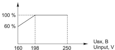
Рисунок 3 – Зависимость выходной мощности от входного напряжения,
