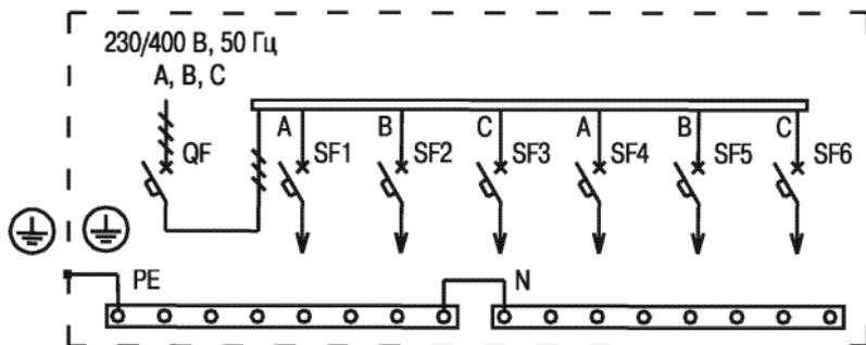
QF – выключатель автоматический ВА47-29 63А 3P C
