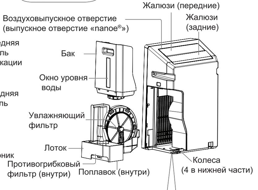
■ **Защелка-фиксатор колес:** нажмите вниз для блокировки колес.
