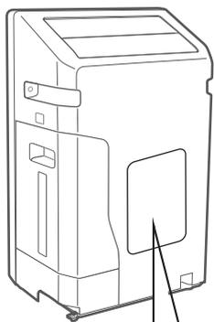
■ Сменный композитный фильтр HEPA
