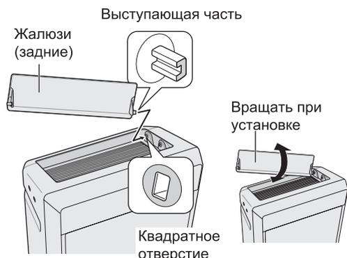
**2** Слегка изогните жалюзи посередине и вставьте противоположную сторону в другое отверстие.
