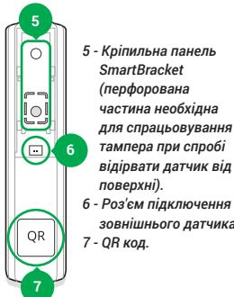
5 - Кріпильна панель SmartBracket (перфорована частина необхідна для спрацьовування тампера при спробі відірвати датчик від поверхні).
