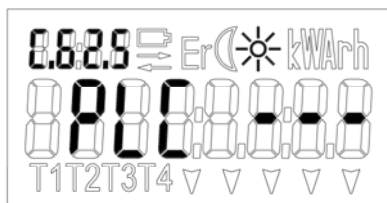
Рис. 6-1 PLC статус “PLC ---“
