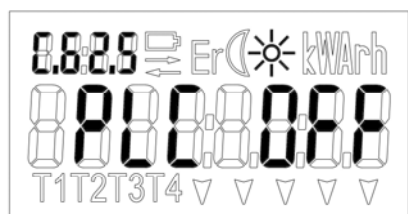
Рис. 6-3 PLC статус “PLC Off“
