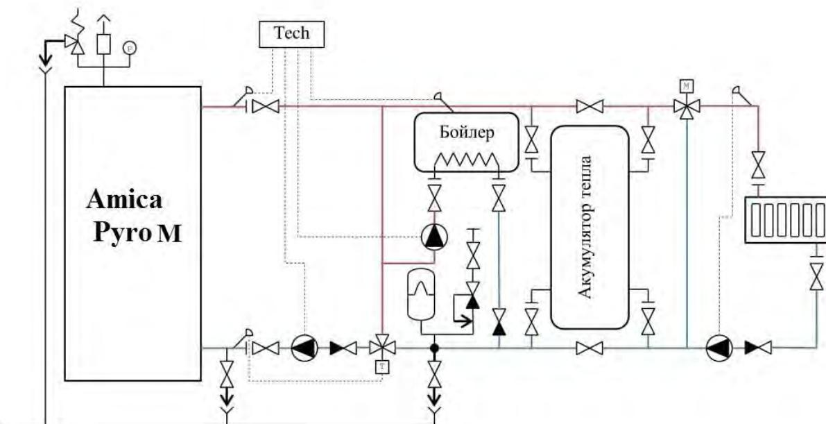
**Рис. 2 – Схема підключення котла Amica Pyro M до системи опалення**
