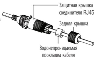
5. Соедините, повернув защитную крышку RJ45 и заднюю крышку по часовой стрелке (в направлении, указанном стрелкой). Когда задняя крышка встанет на место, водонепроницаемая прокладка кабеля плотно прижмется к кабелю, обеспечив его влагозащиту.
