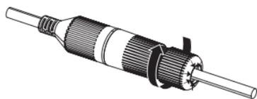
**!** ■ Необходимо полностью собрать узел, повернув заднюю крышку до конца винтовой резьбы соединителя RJ45.
