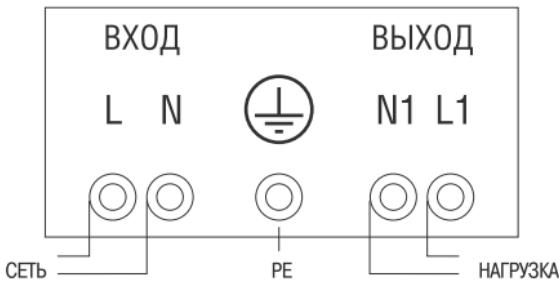
Рис 4. Схема подключения стабилизаторов
