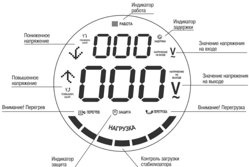
Рис 3. Индикация режимов работы переносных стабилизаторов
