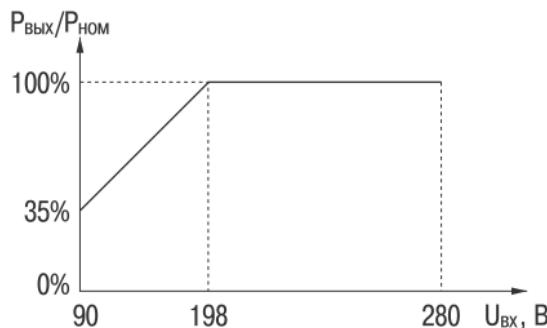
Рис 1. Зависимость выходной мощности от входного напряжения, где  $U_{\text{вх}}$  – входное напряжение,  $P_{\text{вых}}$  – выходная мощность,  $P_{\text{ном}}$  – номинальная (паспортная) выходная мощность
