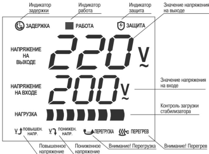
Рис 2. Индикация режимов работы настенных стабилизаторов
