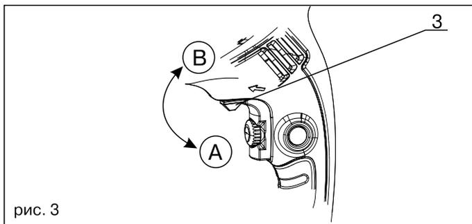
Изменение направления вращения возможно только на выключенном инструменте. Переключателем направления вращения **3** можно изменять направление вращения патрона. Положение **A** - вращение по часовой стрелке. Применяется для сверления и закручивания шурупов. Положение **B** - вращение против часовой стрелки. Применяется для выворачивания винтов/шурупов и отвинчивания гаек.
