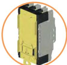
→ Автоматические выключатели серии ETIBREAK 2 в корпусе EB2 125 имеют возможность крепления на шину TH 35 с помощью адаптера. Кроме этого, конструктив корпуса позволяет устанавливать выключатель в одну линейку с модульными автоматическими выключателями (высота 45мм)
