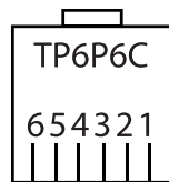
б) обозначение контактов разъема «19» (для исполнений счетчиков с интерфейсами EIA485; EIA232, CE831M0x.03)
