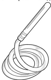
Датчик EK083 может непосредственно подключаться к термостату многодиапазонному EK186. В случае подключения к термостату EK187 необходимо включить в цепь последовательно с датчиком резистор 1500 Ом
