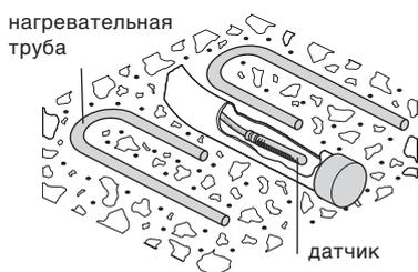
Применение как датчик внешней температуры в водозащитном корпусе
