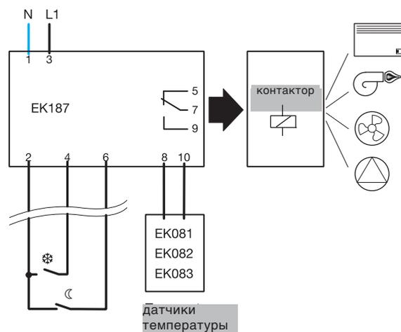
❄ Включение режима "выходного дня" с приоритетом обеспечивается замыканием (беспотенциальным) контактов 2 и 4.
